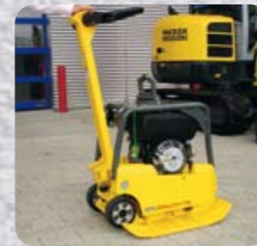
2 Llevar la barra de mando hacia la máquina.
